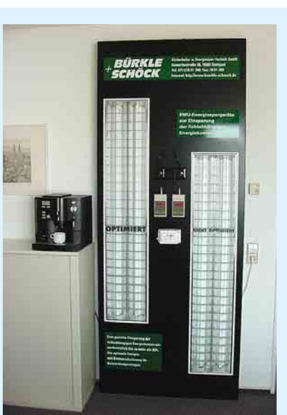
5 Lichtstrom im Vergleich. Lampe links 20520 lx bei 111 W, rechts 21560 lx bei 145 W
